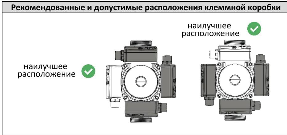
7.13. Для того, чтобы поменять положение клеммной коробки:
