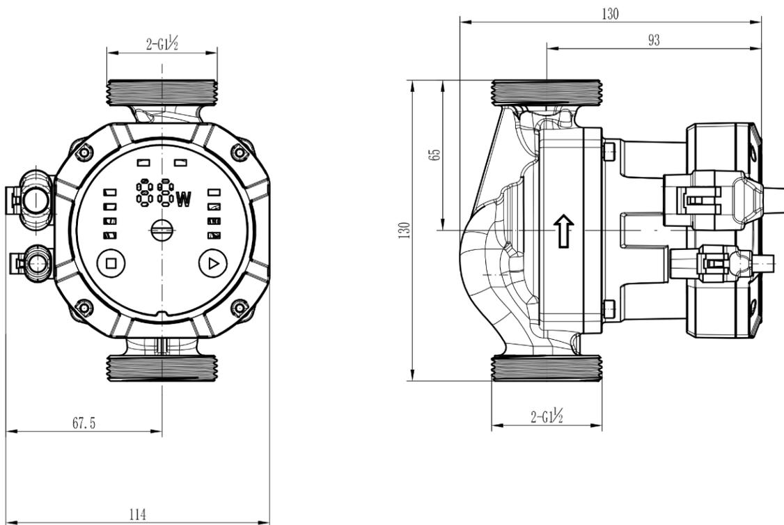
6.3. Размеры насосов с базой 130 мм и термоизоляцией
