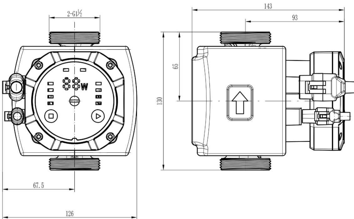
6.4. Размеры насосов с базой 180 мм
