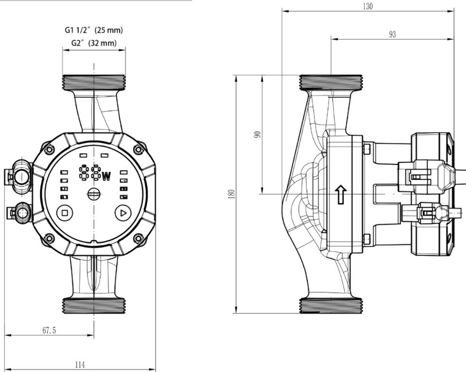
6.5. Размеры насосов с базой 180 мм и термоизоляцией
